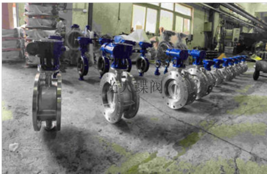
按连接方式分:1、对夹式蝶阀①对夹式蝶阀的蝶板安装于管道的直径方向。阀门则呈全开状态。②对夹式蝶阀结构简单、体积小、重量轻。蝶阀有弹性密封和金属密封两种密封型式。弹性密封阀门，密封圈可以镶嵌在阀体上或附在蝶板周边。2、法兰式蝶阀法兰式蝶阀为垂直板式结构，阀杆为整体式金属硬密封阀门的密封圈；为柔性石墨板与不锈钢板复合式结构，安装在阀体上，蝶板密封面堆焊不锈钢。软密封阀门的密封圈为丁腈橡胶材质，是安装在蝶板上的。
